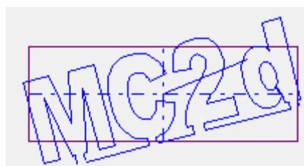
L'outil de déplacement s'utilise en cliquant à l'intérieur de la sélection et en la faisant glisser.
