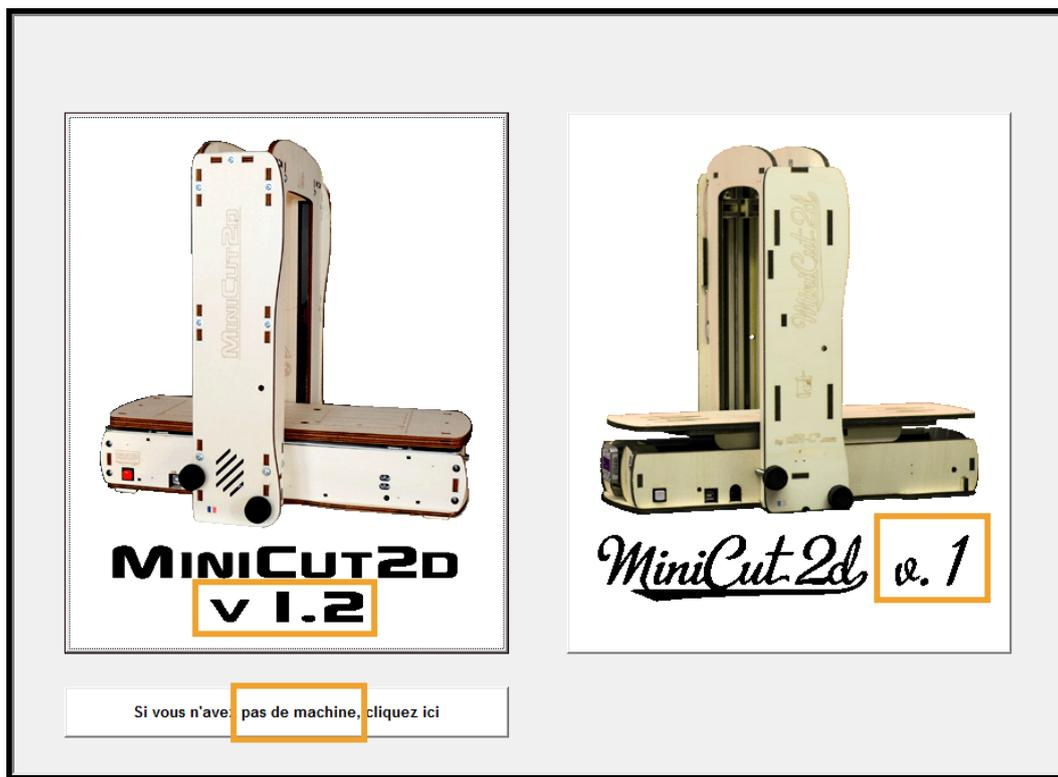
**Attention, ce choix doit être exact ! Utiliser une MiniCut2d v1.2 avec les paramètres d'une v1 ou une MiniCut2d v1 avec les paramètres d'une v1.2 pour vous amener à détériorer le fil et même la machine. Il s'agirait d'une utilisation non conforme !**
