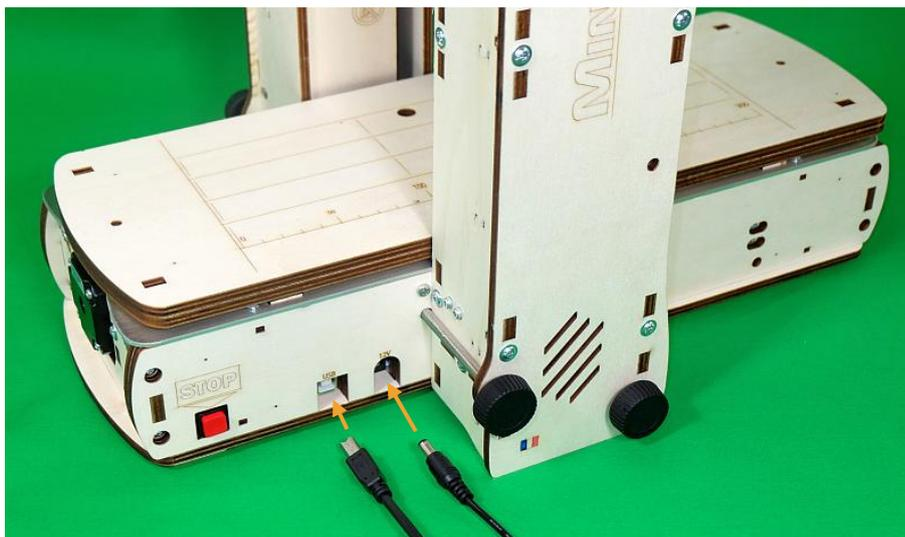
**Si le logiciel MiniCut2d Software est ouvert, il faut le fermer avant de connecter la MiniCut2d au port USB. Cela permettra au logiciel de détecter la machine à sa prochaine ouverture.**
