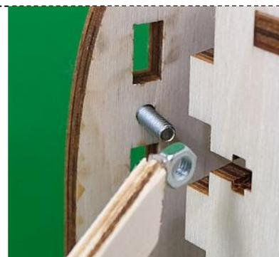
Les moteurs de la MiniCut2d sont montés sur silent-blocs (pour limiter le bruit de fonctionnement). Les silent-blocs ont une longueur précise, attention à ne pas mélanger les différents sachets.
