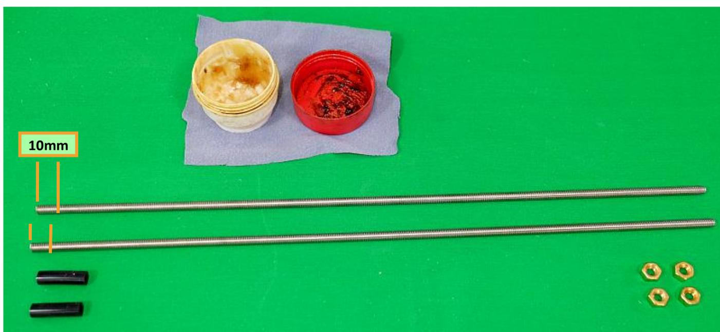
Graisser les tiges filetées et faire circuler les écrous d'un bout à l'autre pour répartir la graisse.
